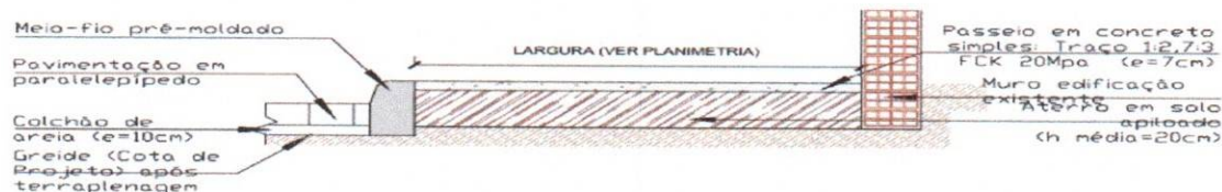
Detalhe 01 – Passeio Para Trechos s/ Alvenaria de 1 Vez escala 25
