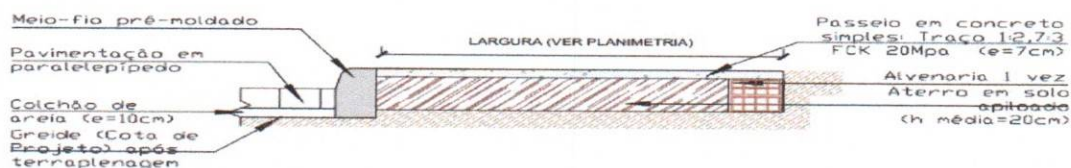
Detalhe 02 – Passeio Para Trechos c/ Alvenaria de 1 Vez escala 25
