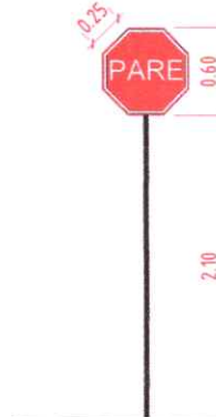
Detalhe - Placa de Parada Obrigatória Esc.: 1:40
