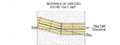
Detalhe 04 - Mudança de direção entre 150° e 180° (D04-MD)
