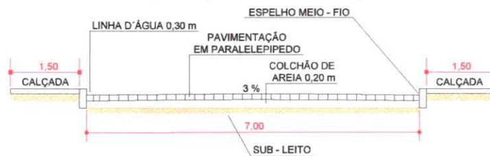
PERFIL TRANSVERSAL RUA PROJETADA ESCALA: 1:75
